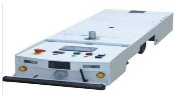
شکل ۴ سامانه حمل بار هدایت‌پذیر خودکار شرکت جهان رو
