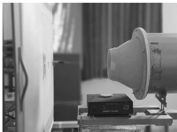
شکل ۶ نمای کناری از چیدمان دمنده، صفحه آزمایش و مدل
