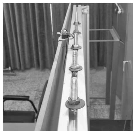
شکل ۷ سیستم اندازه گیری سرعت جابجایی صفحه
