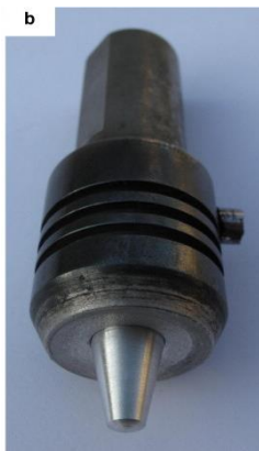
شکل ۱۲ ابزار جوشکاری نقطه‌ای پرکننده [۳۲].
