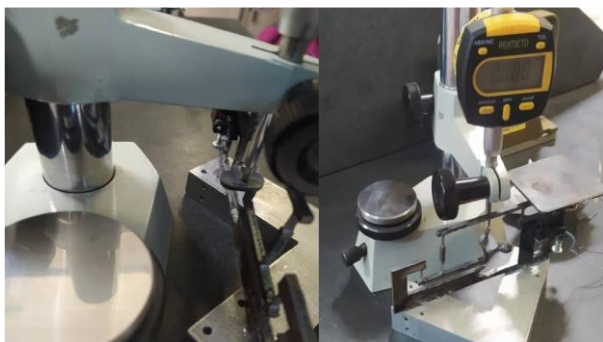
شکل ۱۱ اندازه‌گیری میزان جابه‌جایی با ساعت اندیکاتور
