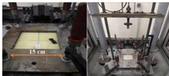
شکل ۵ دستگاه آزمون ضربه به همراه کلمپ کردن قطعه در موقعیت خود
