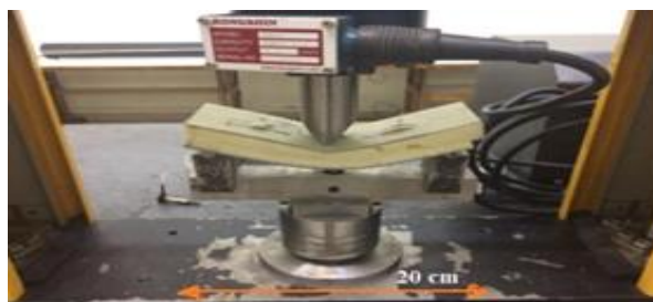
شکل ۶ یکی از نمونه ساندویچ پانل ها هنگام بارگذاری خمشی
