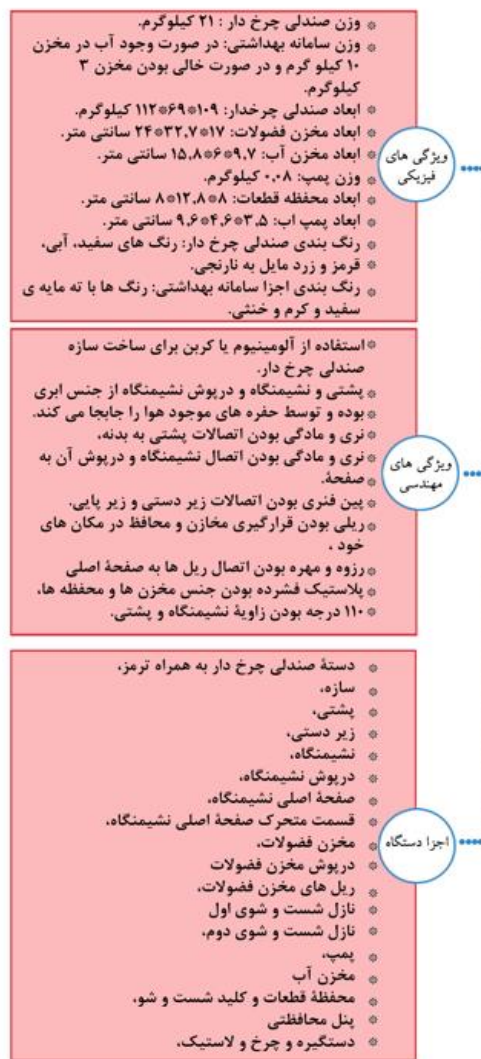
شکل ۱۹ ویژگی‌های فیزیکی، مهندسی و اجزای صندلی چرخدار صابیتا
