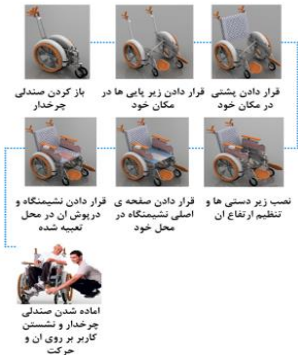
شکل ۲۰ سناریوی استفاده از صندلی چرخدار صابیتا بدون نیاز کاربر به سامانه خدمات بهداشتی
