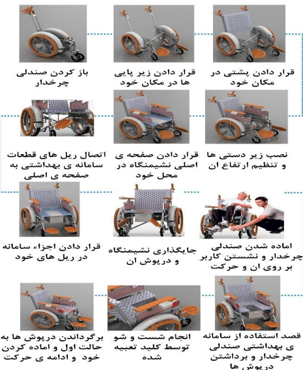
شکل ۲۱ سناریوی استفاده از صندلی چرخدار صابیتا برای جابجایی و استفاده هم‌زمان از سامانه خدمات بهداشتی
