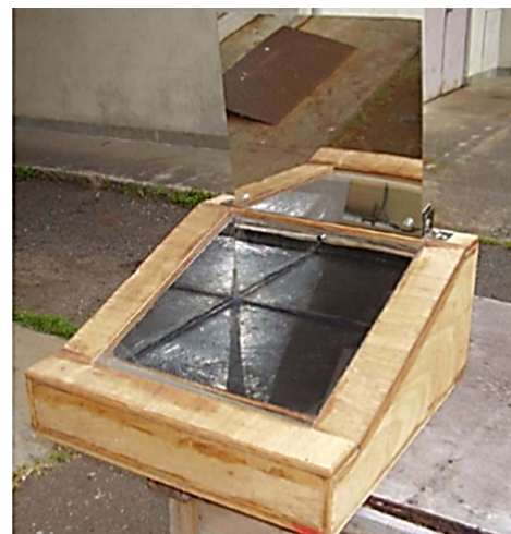
شکل ۲۲: آب شیرین کن معمولی همراه با بازتاب‌دهنده‌های داخلی و خارجی [۲۷].
