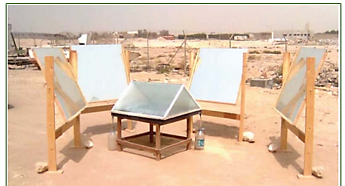
شکل ۱۸: آب‌شیرین‌کن دو سطح شیب‌دار با بازتاب‌دهنده‌های خارجی [۲۳].
