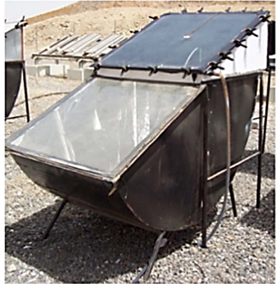
شکل ۱۷: آب‌شیرین‌کن خورشیدی با بازتاب‌دهنده خارجی منحنی شکل [۲۲].
