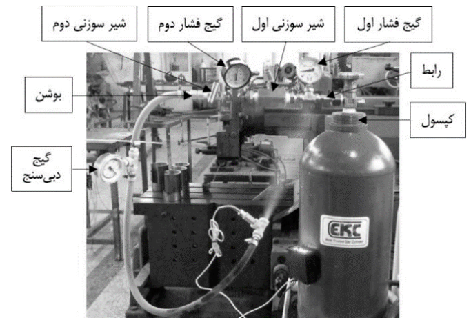
شکل ۹: مدار با یک خروجی شامل کپسول، گیج فشار اول، شیر سوزنی اول، گیج فشار دوم، شیر سوزنی دوم، گیج دبی‌سنج. نحوه اندازه‌گیری دما نیز نمایان است.
