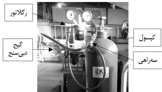
شکل ۶: مدار با دو خروجی شامل کپسول، رگلاتور و گیج دبی‌سنج.
