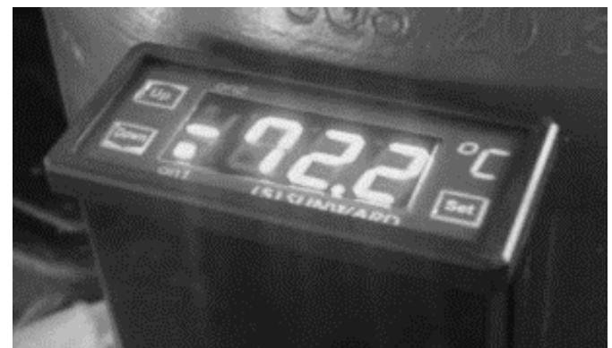
شکل ۱۰: نمایش دمای اندازه‌گیری شده ۷۲/۲- درجه سانتی‌گراد توسط ترموستات برای مداری که قابلیت تحویل سیال را به صورت پیوسته دارد.
