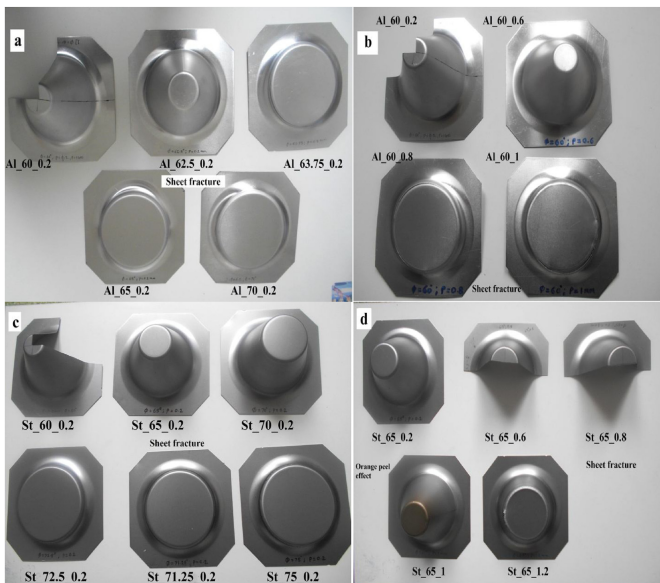
شکل ۴۲: قسمت‌هایی از فرایند شکل‌دهی تک نقطه‌ای [۴۱].
