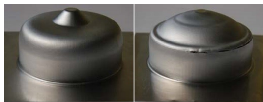
شکل ۱: شکل دهی چندمرحله‌ای، تأثیر تفاوت در مسیر حرکت ابزار [۳].
