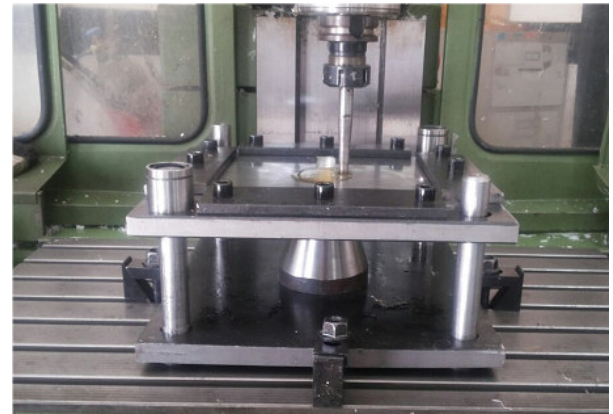
شکل ۴۰: تست تجربی شکل‌دهی نموی دو نقطه‌ای [۳۹].
