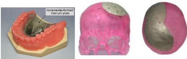
شکل ۹: ساخت پوسته فلزی جمع‌بسته [۱۱]. بخشی از دندان مصنوعی [۱۲].
