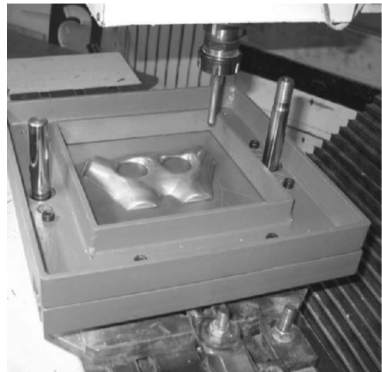
شکل ۱۲: نمونه آزمایشگاهی از شکل دهی نموی دونقطه‌ای قالب کامل [۱۵].
