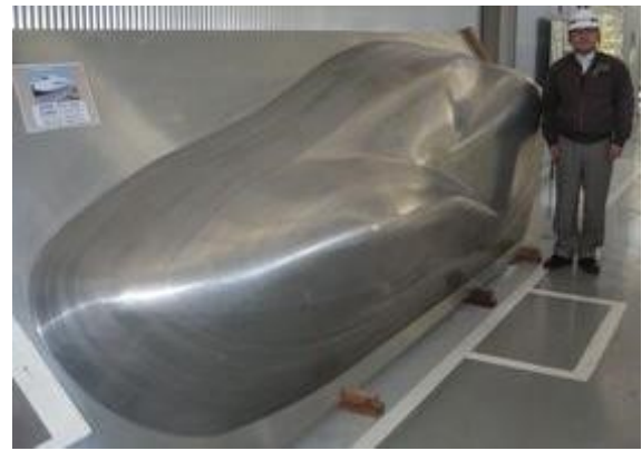
شکل ۶: ساخت نمونه دماغه قطار توسط فرآیند (ISF) [۹].
