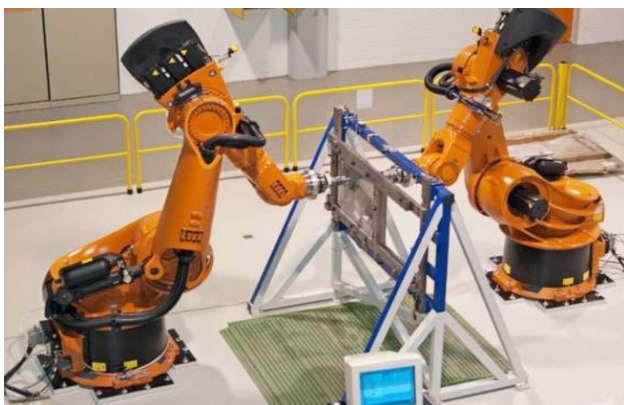
شکل ۲۰: شکل دهی نموی از طریق ترکیب دو ربات [۱۴].
