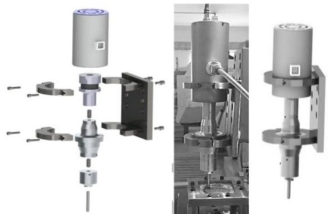
شکل ۱۸: شکل دهی نموی با کمک نوسانات مافوق صوت [۱۹].
