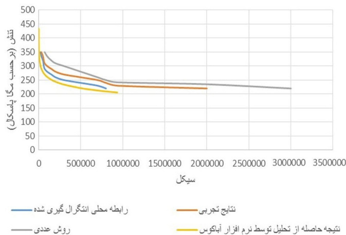
شکل ۱۰: مقایسه نمودار تنش-عمر خستگی حاصله از تحلیل در نرم افزار آباکوس با نتایج تجربی و عددی ارائه شده در مرجع [۱۷].
