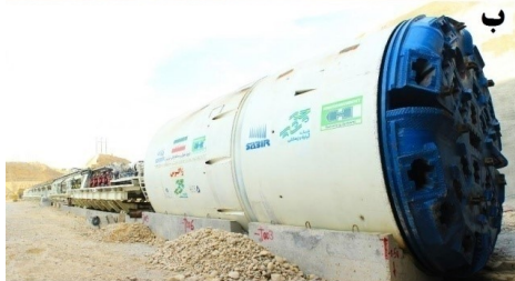
شکل ۶: (الف) فرسایش و خوردگی سپر و کاترهد پس از حفاری تونل انتقال آب حلب سوریه. (ب) دستگاه بازسازی شده برای پروژه چمشیر.
