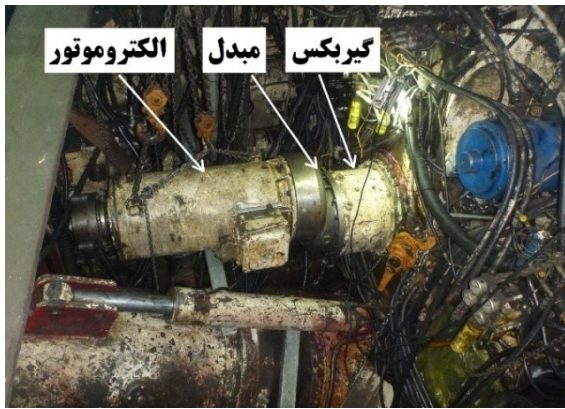
شکل ۱۳: قرارگیری مبدل‌ها مابین گیربکس‌ها و الکتروموتورها.
