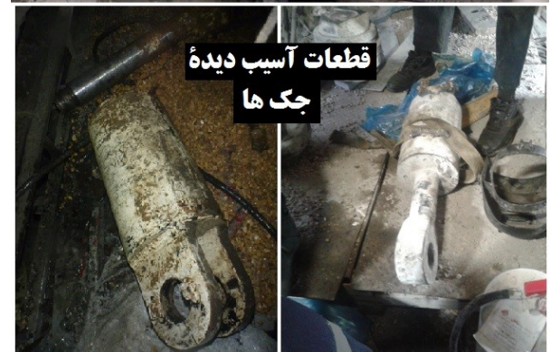
شکل ۱۵: شکستگی جک‌های پسو و فاصله ایجادشده بین دو سپر میانی و انتهایی.
