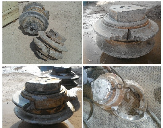
شکل ۱۰: شکستگی دیسک‌های برشی دوبل (دو تیغه).
