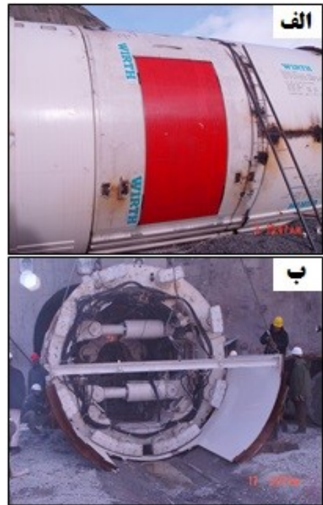
شکل ۳: (الف) نمایی از صفحه فلزی دیوارگیرها. (ب) نمایی از جک های متصل به دیوارگیرها.
