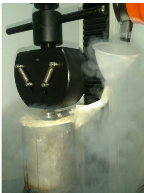
شکل ۴: انجام آزمایش کشش ساده در دمای فوق‌سرد (تزریق نیتروژن مایع)
