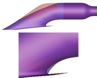
شکل ۹: شکل اصلاح‌شده واترجت در مقایسه با هندسه اولیه
