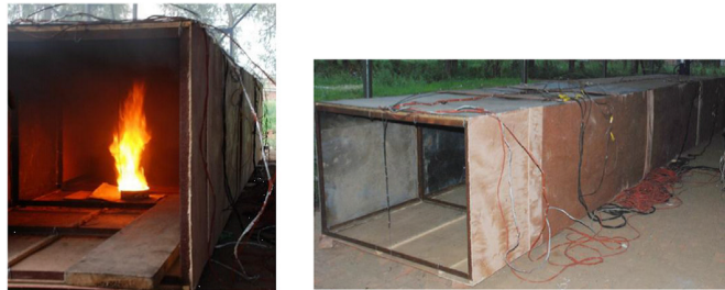
شکل ۱۶: تونل مورد استفاده جهت انجام تست‌های آزمایشگاهی [۱۹].
