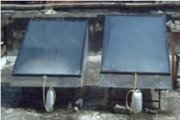
شکل ۵: آب شیرین‌کن با ماده تغییر فاز دهنده (سمت راست) آب شیرین‌کن خورشیدی بدون ماده تغییر فاز دهنده (سمت چپ)
