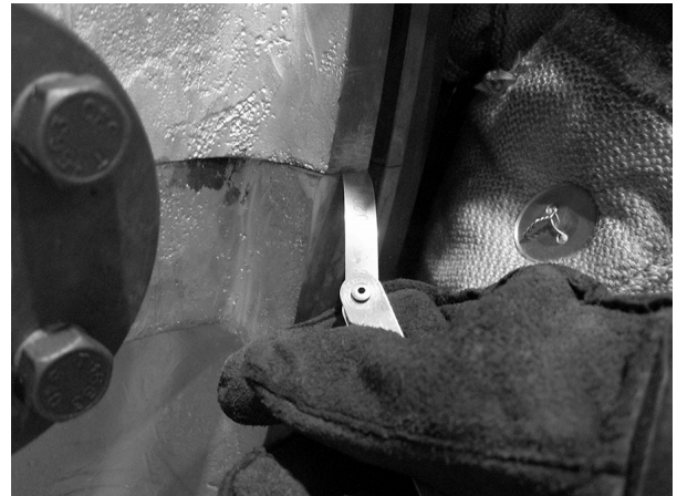
شکل ۶: شناسایی تغییر شکل پوسته کمپرسور یک توربین گاز با فیلرزی
