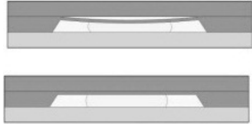
شکل ۴: پارافین جامد و مدار در حالت باز (بالا) - پارافین ذوب شده و مدار در حالت بسته (پایین) [۴]
