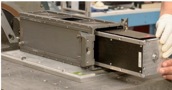
شکل ۱۳: ماهواره مکعبی به همراه رادیاتور کامپوزیتی در حال آماده شدن جهت تست ارتعاش [۹]
