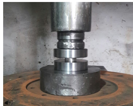
شکل ۷: تصویر نمونه‌ها حین آزمون فشار حلقه
