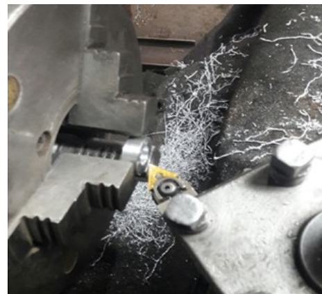
شکل ۶: تولید نمونه‌های حلقه با دستگاه تراش
