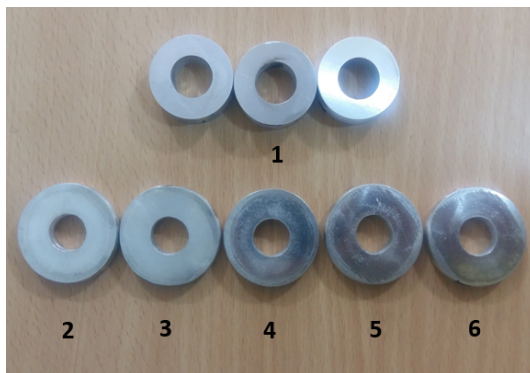
شکل ۸: نمونه‌های تغییر شکل یافته تحت حالت‌های مختلف روانکاری (۱) حالت اولیه نمونه، (۲) حالت خشک، (۳) روغن ۱۰، (۴) روغن جوانه گندم، (۵) روغن زیتون و (۶) روغن کتان
