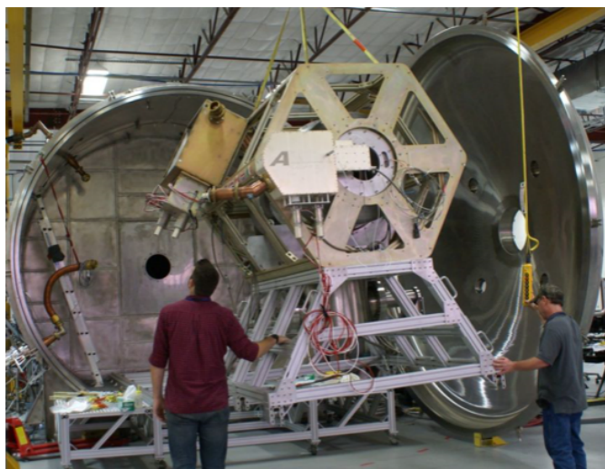
شکل ۱: نمونه عملیاتی پیشرانه واسمیر ساخته شده توسط ناسا [۵]
