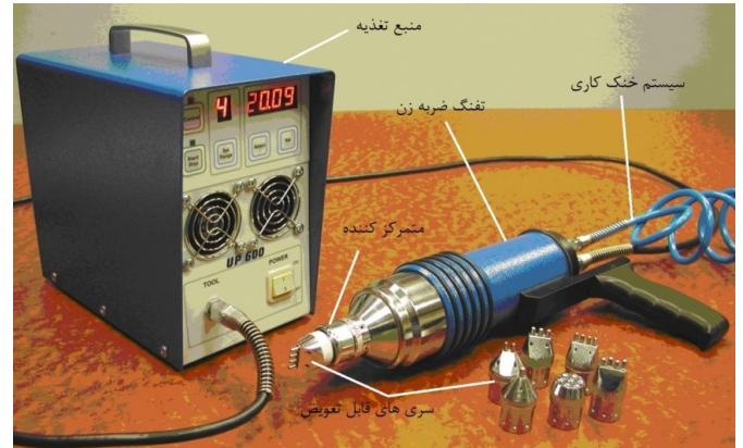
شکل ۱: ساختمان کلی دستگاه کوبش اولتراسونیک [۹]
