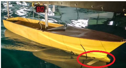
شکل ۱۱: استفاده از هیدروفویل در زیر سینه شناور جهت بهره‌گیری از انرژی موج [۸]
