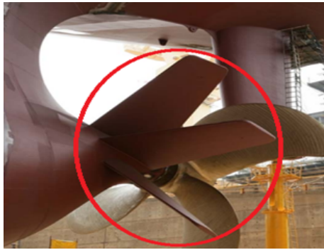
شکل ۴: نصب استاتور ثابت با گام‌های مخالف گام پروانه بین پروانه و شناور [۸]
