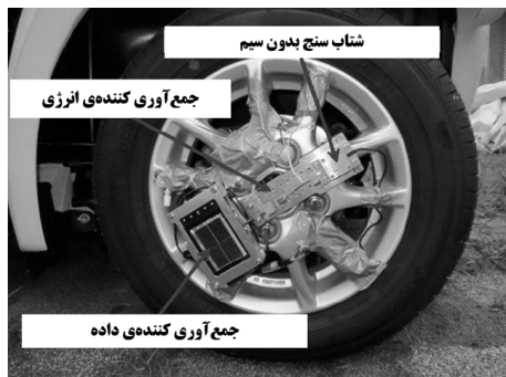
شکل ۱۳: دستگاه آزمایش سیستم برای خودروی واقعی [۱۴]
