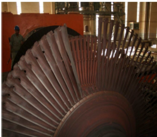
شکل ۱۰: شکست پره توربین بخار با وجود سیم مستهلک کننده [۲۵]
