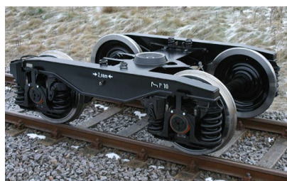
شکل ۱: نمونه‌ای از بوژی مدل Y25 [۱]
