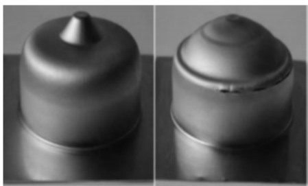
شکل ۳۵: تغییر در کیفیت قطعه در شکل دهی تدریجی چندمرحله‌ای نسبت به یک مرحله‌ای. اما مشکل وجود برآمدگی در کف ظرف [۳۲]
