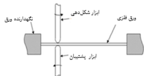
شکل ۲: شکل‌دهی تدریجی دونقطه [۵]
