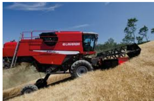
شکل ۹: تصویر نمونه‌ای از ماشین‌آلات مجهز به سیستم تراز
