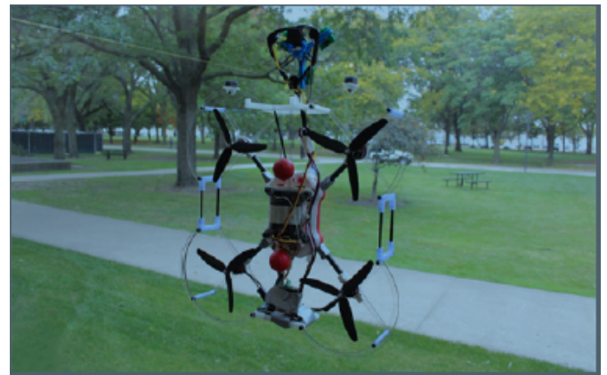
شکل ۲۱: کوادروتور چسبیده به دیواره شیشه‌ای با چسبندگی مارمولکی گریپر متصل به بدنه [۳۶]
