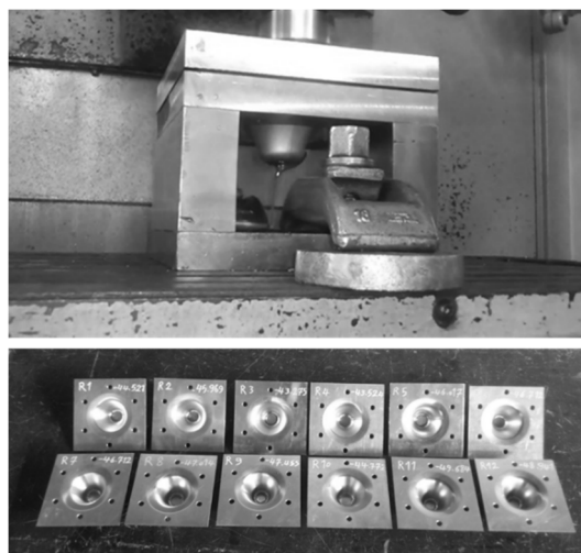
شکل ۵. نشن روغن در هنگام شکست و نمونه‌های تغییر شکل یافته در ۱۲ حالت مختلف
