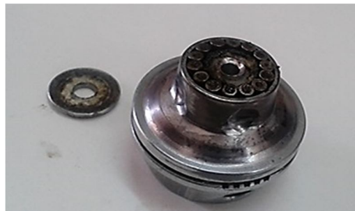
شکل ۱۴. جدا کردن درپوش یاتاقان از قطعات دوار فلزی
