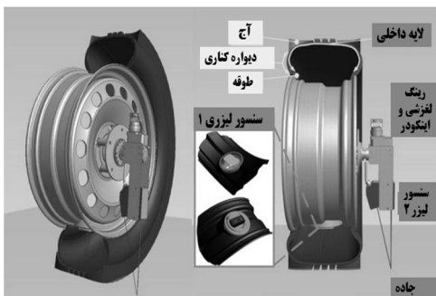
شکل ۱۱. نمونه‌ای از سیستم لیزری برای اندازه‌گیری تغییر شکل آج تایر
