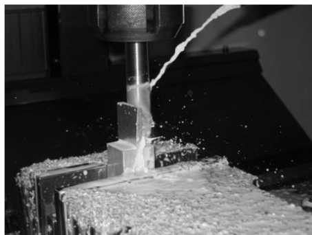
شکل ۱۲. خشن کاری قطعات آلومینیومی
