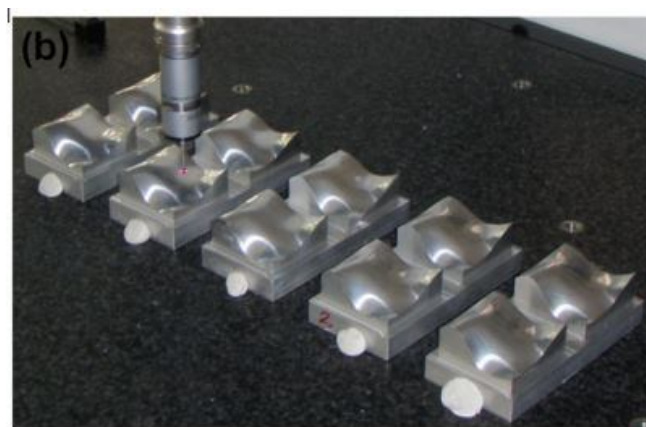
شکل ۱۳. بازرسی قطعات با موقعیت مشابه روی ماشین اندازه‌گیری مختصات [۱۸]
