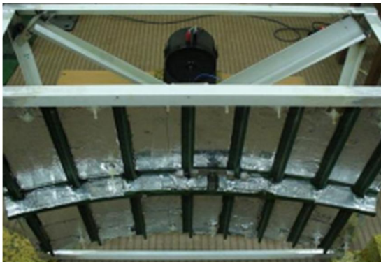
شکل ۱۳. دستگاه تست ارتعاشی جاذب [۲۴]
