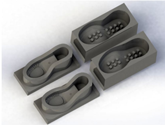
شکل ۱۶. قالب تزریق زیره طراحی شده در نرم افزار سالیدورکس
