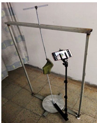
شکل ۱۳. وسیله ابداع شده برای عکاسی از قالب کفش برای تهیه ابر نقاط
