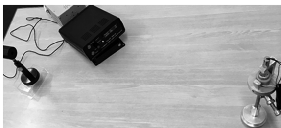
شکل ۱۱. نمونه اندازه‌گیری توان لیزر با بازوی صلب
