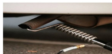
شکل ۱. آزمون گازهای خروجی از اگزوز
