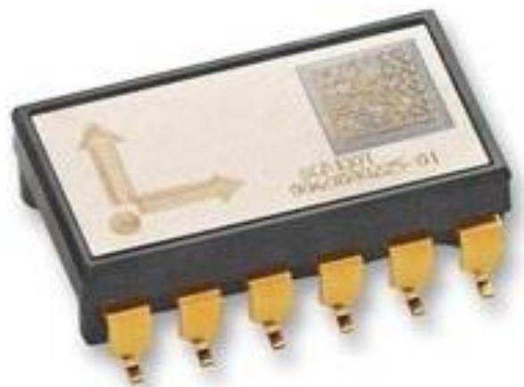
شکل ۷ سنسور شیب‌سنج SCA100T-D02
