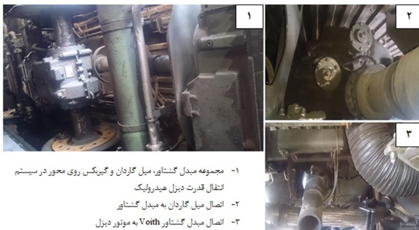
شکل ۱۳. مجموعه سیستم انتقال قدرت دیزل - هیدرودینامیک در ترنست پردیس
