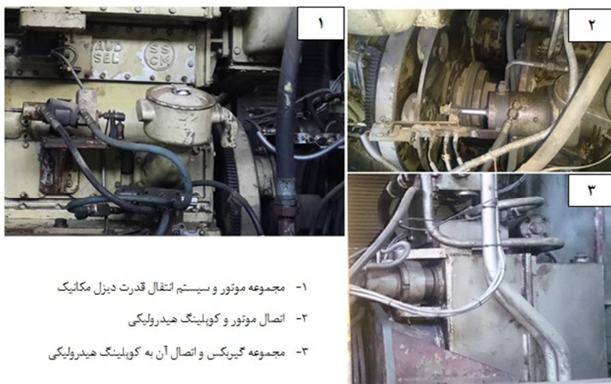
شکل ۱۲. مجموعه سیستم انتقال قدرت دیزل - مکانیک در لوکوموتیو مانوری SECMAFER
