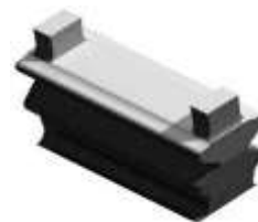
شکل ۴ نمای سه بعدی ریشه متصل کننده پره به دیسک
