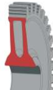
شکل ۱ نمای برش خورده دیسک دوجانه در توربین فشار بالا [۹]
