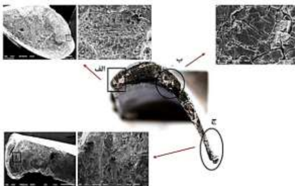
شکل ۱۹ تصاویر SEM از سه ناحیه مختلف سطح شکست، (الف) تصویر رشد ترک از لبه حمله به سمت لبه فرار، (ب) شکست درون دانه‌ای در طول ترک‌های مرز دانه‌های ثانویه و (ج) وجود خطوط خستگی در این ناحیه [۱۳۹]
