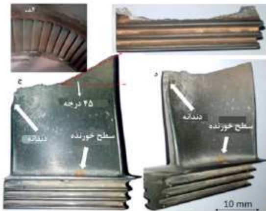
شکل ۲۲ نماهای مختلف پره‌های شکسته شده، الف- پره‌های کمپرسور، ب- آسیب پره از ناحیه ریشه، ج و د- شکست ۴۵ درجه پره توربین [۱۴۳]
