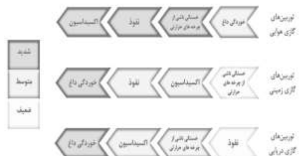
شکل ۹ انواع مختلف آسیب در اجزاء توربین های گازی هوایی، زمینی و دریایی
