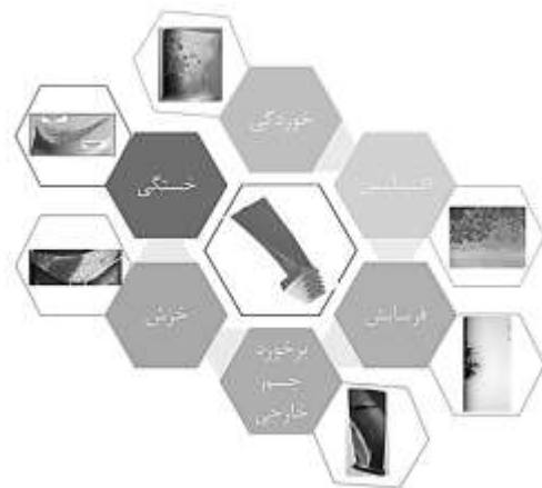
شکل ۷ انواع سازوکارهای تخریب پره های توربین
