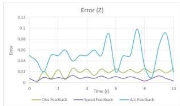
شکل ۱۴ خطای حاصله بین دو کنترلر PID و تطبیقی برای جابجایی حرکت عمودی ( Z )
