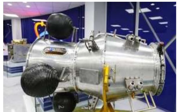
شکل ۳ نمایی از بلوک انتقال مداری و مخازن تحت فشار ساخته شده در پژوهشگاه فضایی ایران
