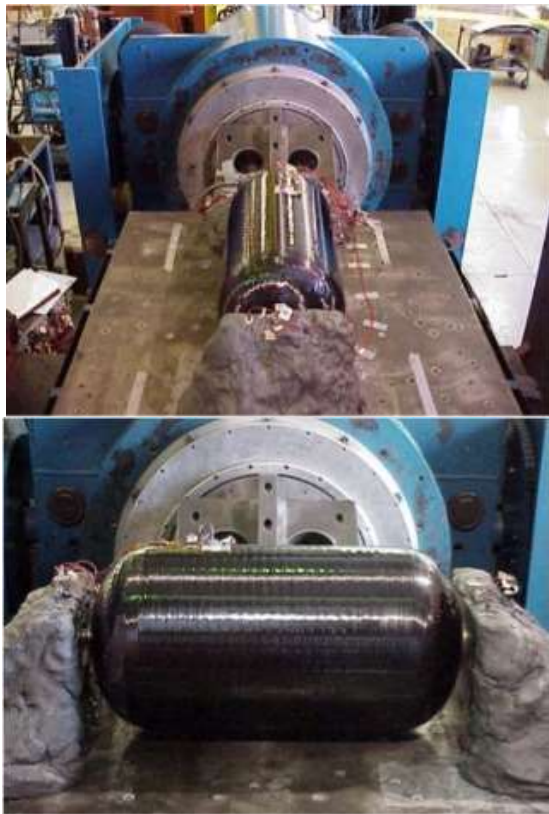
شکل ۱ شماتیکی از تست ارتعاش تصادفی مخازن تحت فشار کامپوزیتی با لاینر فلزی با گاز زنون [۱۲]
