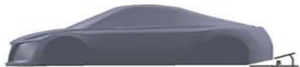
شکل ۷ انحنا و دیفیوزر زیر بدنه [۱۱]
