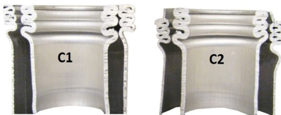
شکل ۶. نمای برش‌خورده فروریزش لوله دوجداره توخالی پس از جابه‌جایی ۴۵ میلی‌متر صفحه صلب فوقانی
