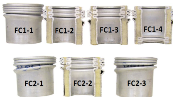
شکل ۹. فروریزش لوله‌های دوجداره تقویت‌شده با فوم با چگالی مختلف پس از جابه‌جایی ۴۵ میلی‌متر صفحه صلب فوقانی
