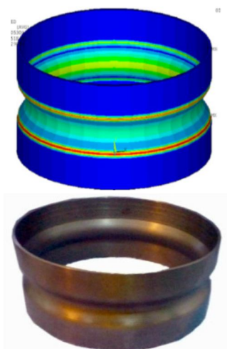
شکل ۱۴. مقایسه کاهش قطر موضعی لوله فولادی با نتایج عددی [۱۵]
