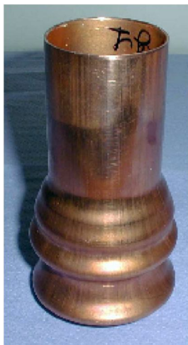
شکل ۱۶. چین خوردگی در لوله به‌سبب اصطکاک زیاد بین لوله و قالب [۱۶]
