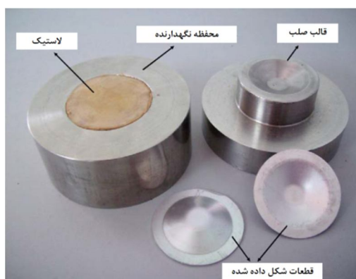
شکل ۷. ورق‌های شکل داده شده به همراه مجموعه قالب [۹]
