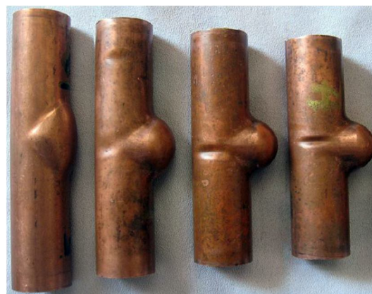
شکل ۱۳. لوله‌های مسی تی. شکل تولیدشده با ابزار الاستومری [۱۳]
