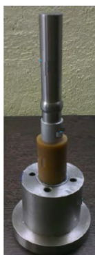
شکل ۱۸. لوله و الاستومر مورد استفاده به همراه برخی از قطعات شکل داده شده [۱۸]
