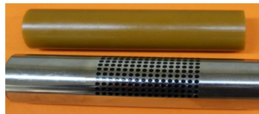
شکل ۱۸. لوله و الاستومر مورد استفاده به همراه برخی از قطعات شکل داده شده [۱۸]
