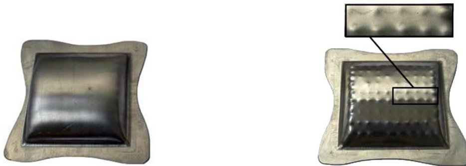
شکل ۱۰. عیب تورفتگی در قطعه بدون استفاده از لایه الاستومری، و استفاده از لایه الاستومری برای رفع این عیب [۱۰]
