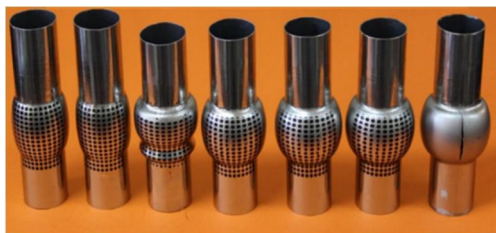
شکل ۱۸. لوله و الاستومر مورد استفاده به همراه برخی از قطعات شکل داده شده [۱۸]
