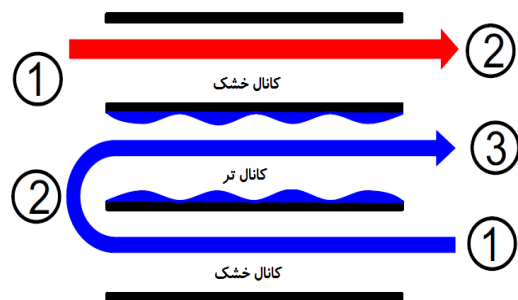
شکل ۸ شماتیک چرخه‌ی اصلاح‌شده‌ی مایسوتسنکو [۱۷]
