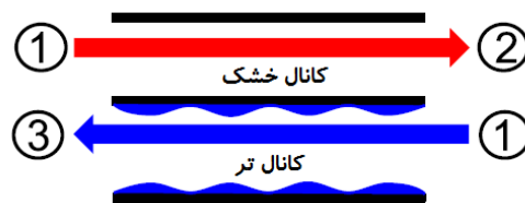
شکل ۴ شماتیک سيستم سرمايش تبخیری غيرمستقيم [۱۷]
