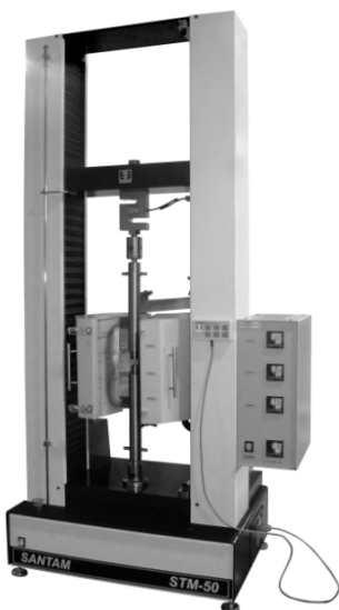
شکل ۳ دستگاه انیورسال سنتام STM-50 مجهز به واحد ثبت تغییرات نیرو و کوره حرارتی الکتریکی.
