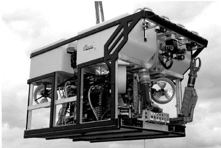
شکل ۸ اجزای یک ربات زیرسطحی شامل: بازوی مکانیکی، دوربین ویدیویی، مهاربندی و کابل، قاب فلزی تحتانی، پیشراشه و بسته شناوری
