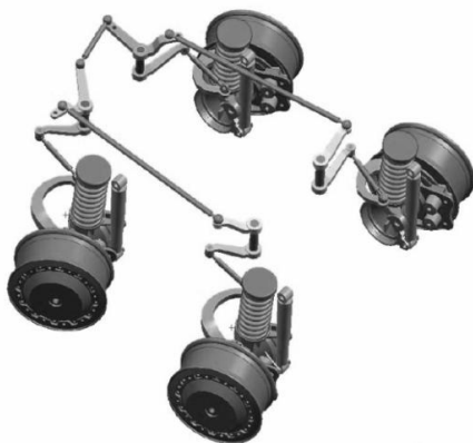
شکل ۹. سازوکار چندمیله‌ای سیستم فرمان در دو محور در یک نفربر نظامی
