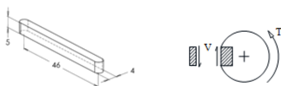
شکل ۱۰. دیاگرام آزاد محور خروجی جعبه‌دنده و خار مستطیلی
